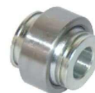
MTP 500196 - 20806212 Rolamento Garfo Emb. Cambio VT FH/NH/FM
