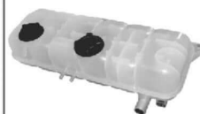
MTP 300800 - 1674916 Tanque Expansão NH
